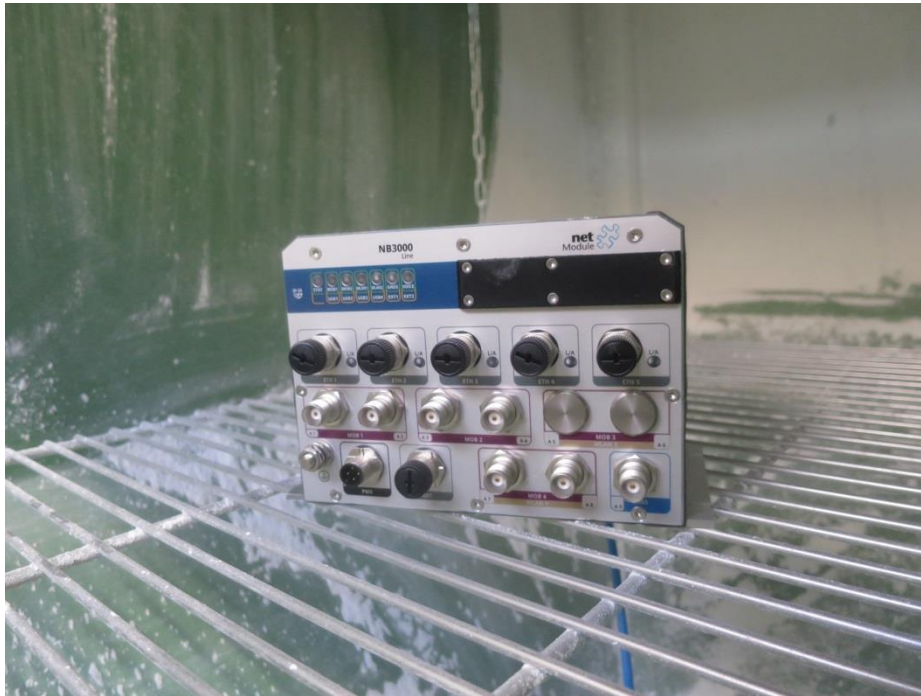
Arrangement of device under test in the dust chamber before the dust test Geräteanordnung in der Staubkammer vor der Staubprüfung
