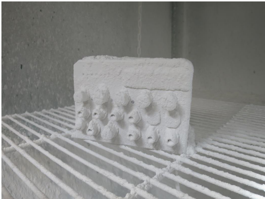
Arrangement of device under test in the dust chamber after the dust test Geräteanordnung in der Staubkammer nach der Staubprüfung
